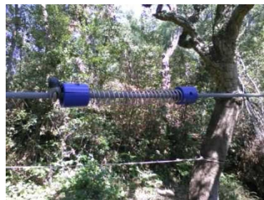
Image 24: Ressorts pour freiner l'impact des tyroliennes. Source: Élaboration personnelle
